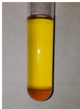
Figura 3: Sistema bifásico observado en la transesterificación de aceite de girasol usado con alcoholes lineales, catalizado con Eversa® Transform.
