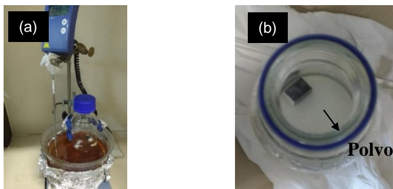
Figura 1. a) configuración del reactor utilizado en la síntesis. b) monolito y polvo obtenido luego de la síntesis.
