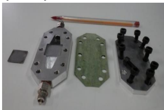
Figura 2: Fotografía prototipo evaluación catalítica microreactores
