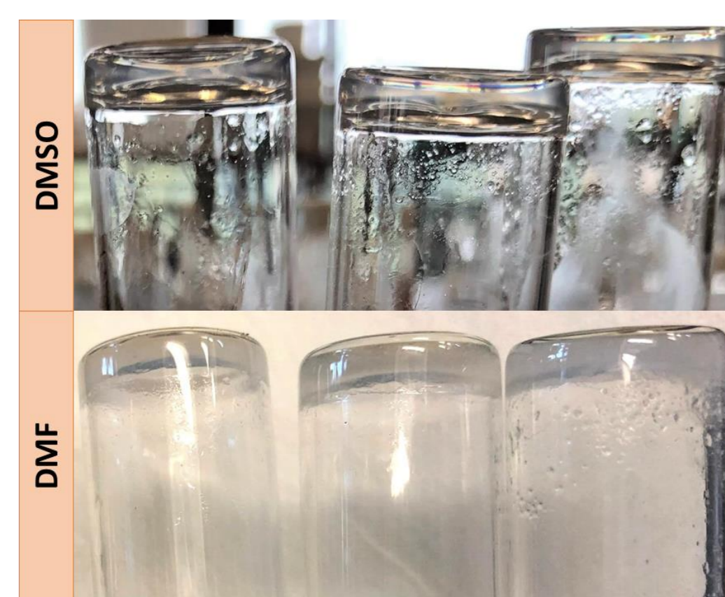
Figura 2. Geles de PheCom en DMSO (arriba) y DMF (abajo) de distintas concentraciones entre 0,45 mg/mL y 10 mg/mL.
