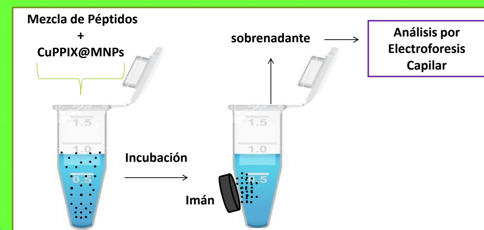
La EC fue realizada en el equipo P/ACE MDQ, usando BP 50 mM, pH 4 como electrolito background (BGE). Las muestras (sobrenadante de la incubación) fueron introducidas a 5 s, con 3,5 kPa y la separación se realizó a un voltaje de 20 kV.
