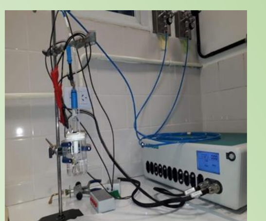
Imagen 1: Potenciostato – Galvanostato Metrohm- Autolab y celda utilizada para mediciones Voltamperométrica
