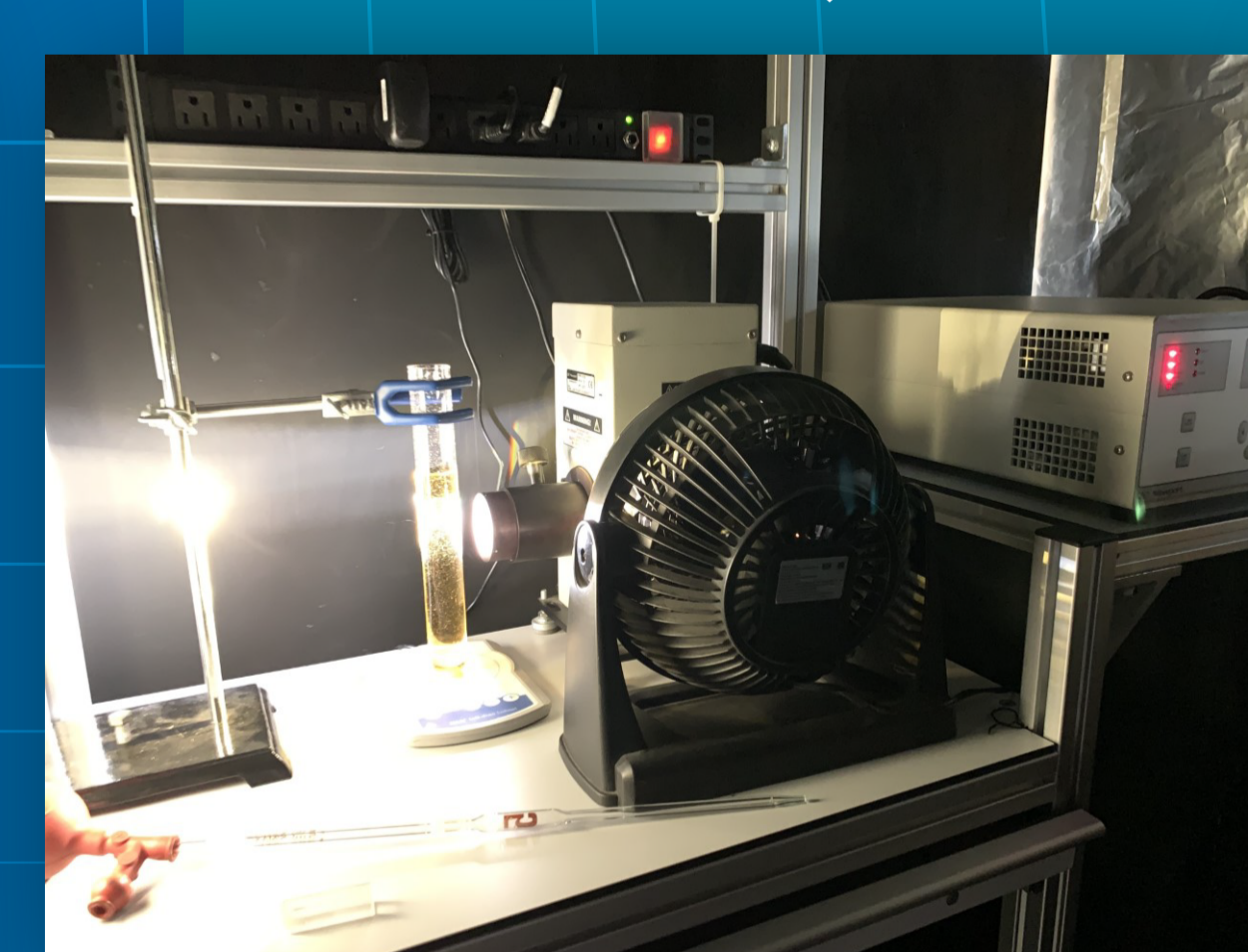
Fig. 8 CN con irradiación de simulador solar
