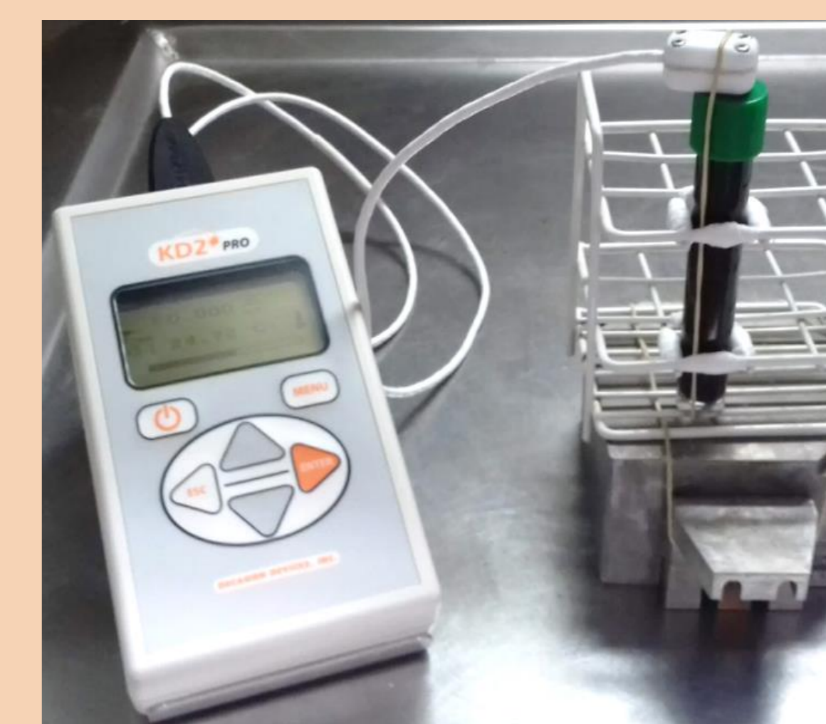
Fig. 4. Montaje utilizado para medir la conductividad térmica.
