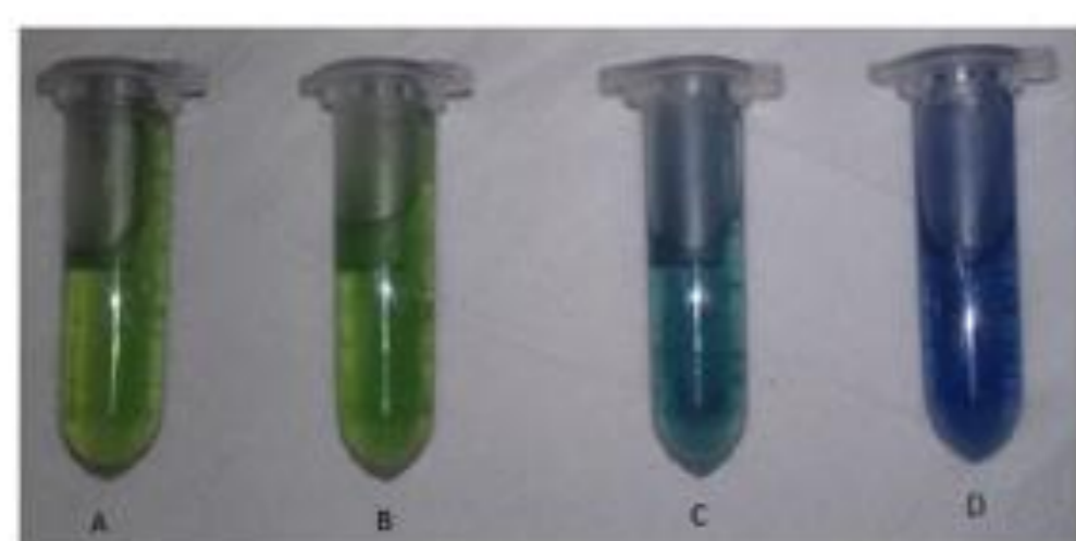
Figura N°4 : (arriba) tabla de tamaños e índice de polidispersidad de las NPs PANI/PVP , (abajo) fotografía de NPs PANI/PVP a diferentes PH.
