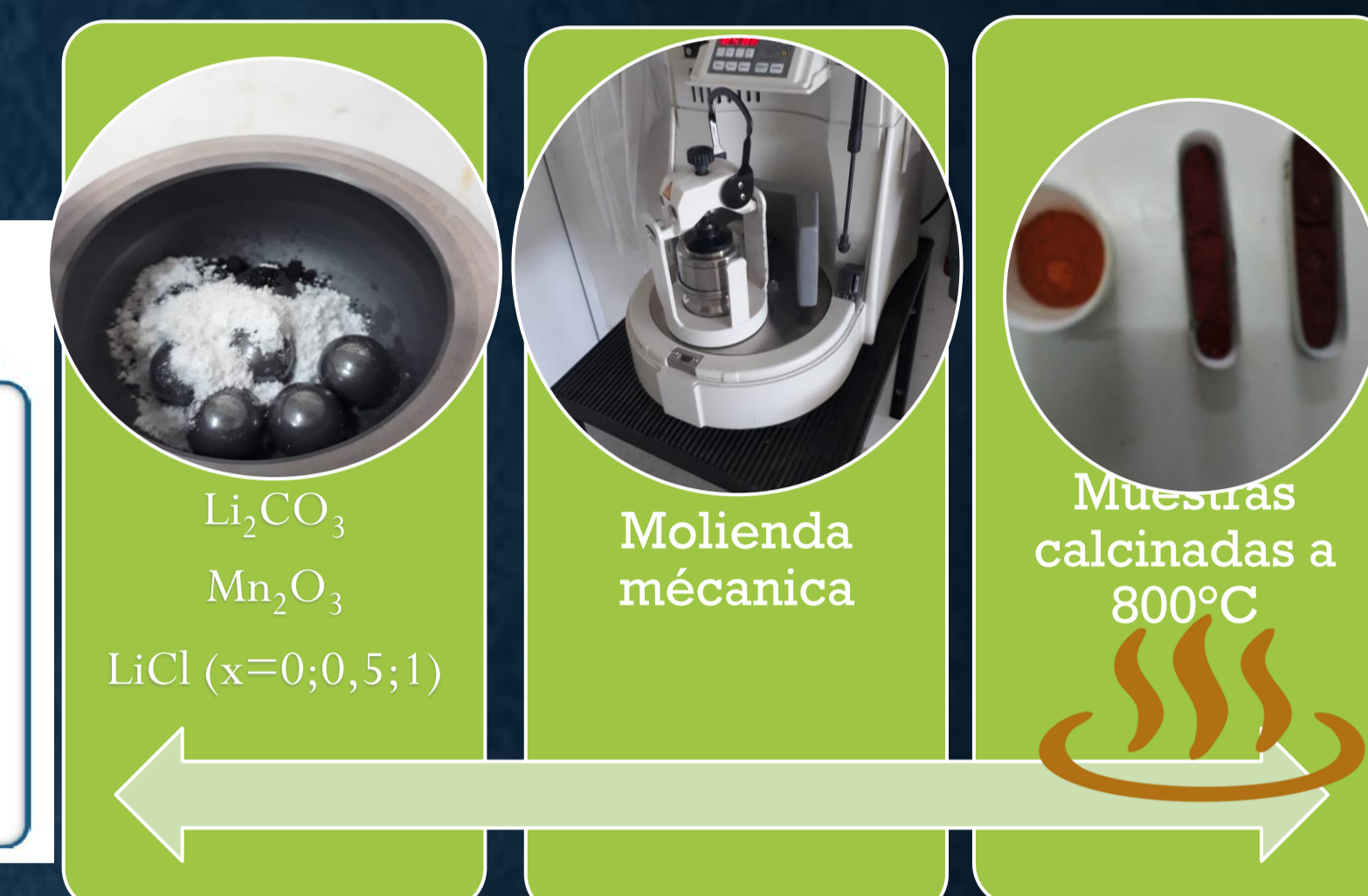
Fig. 2: Procedimiento de síntesis: carga de los reactivos al vial, molienda, calcinación y caracterización de las muestras obtenidas
