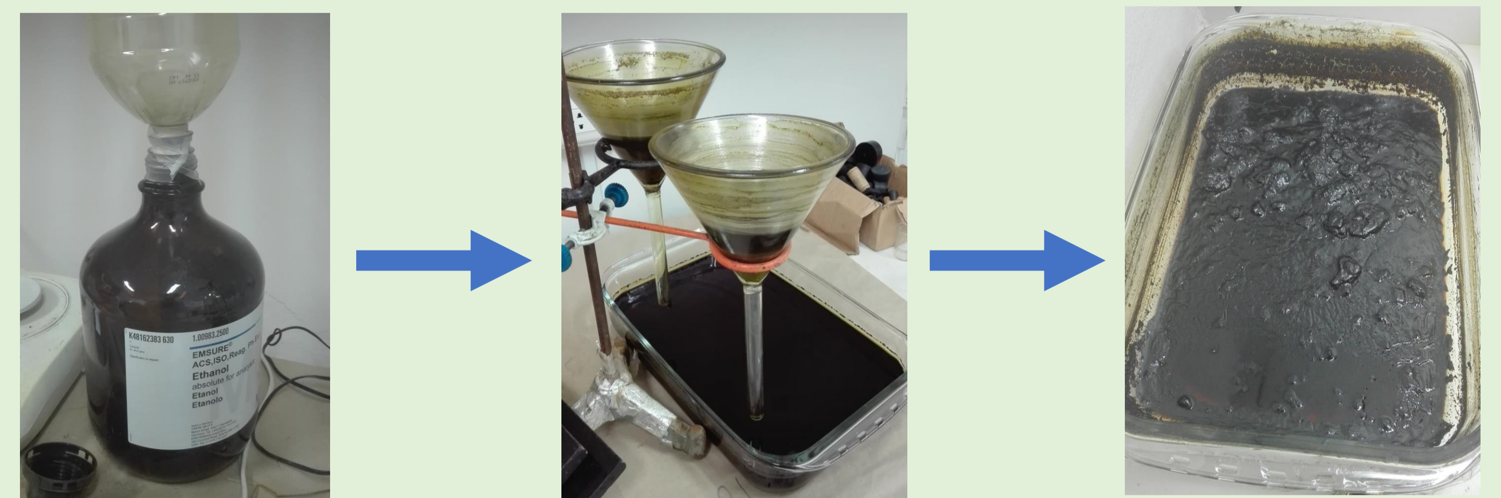
Figura 3. Proceso de extracción: i) Maceración con etanol. ii) Filtración del extracto. iii) Concentración del extracto.
