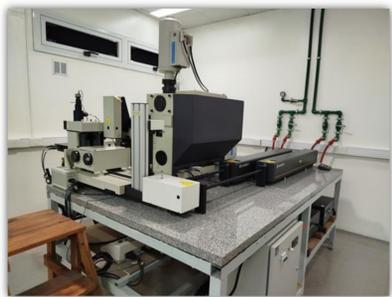
Espectrofotómetro Raman Horiba Jobin Yvon T64000 utilizado en las medidas.
