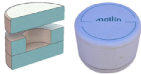
Detalle de la morfología de las cápsulas refractarias desarrolladas. A la izquierda la vista de un corte transversal. A la derecha foto de un prototipo real.
