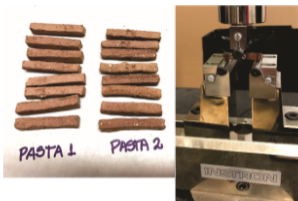
Figura 1. Probetas calcinadas (izq.). Ensayo de resistencia a la flexión en tres puntos. (der.).
