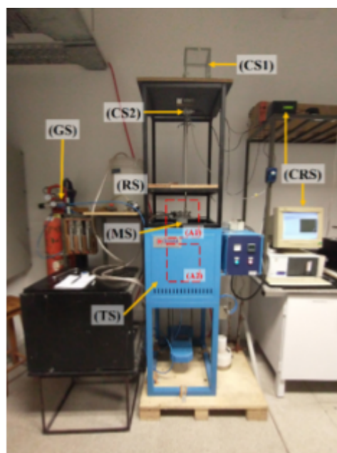
Equipo para la evaluación de la corrosión gaseosa
